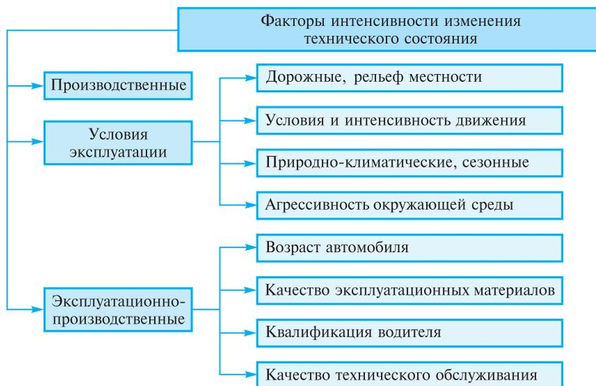
Рис. 1.6. Классификация факторов влияния на интенсивность изменения технического состояния автомобилей
